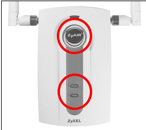
Sobald das Gerät mit Strom versorgt wird, beginnen die LED-Anzeigen **PWR** und **ZyAIR** zu leuchten. Die LED-Anzeige **ETHN** beginnt zu leuchten, wenn der **ETHERNET**-Anschluss richtig angeschlossen ist.
