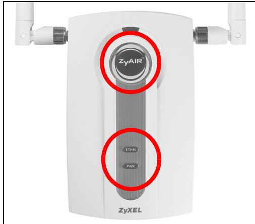
指示灯 **PWR** 和 **ZyAIR** 会在连接电源后亮起。如果 **ETHERNET** 端口连接正常，则 **ETHN** 指示灯会亮起。
