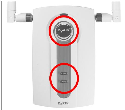
Los LEDs **PWR** y **ZyAIR** se encienden cuando la corriente está conectada. El LED **ETHN** se enciende si el puerto **ETHERNET** está correctamente conectado.
