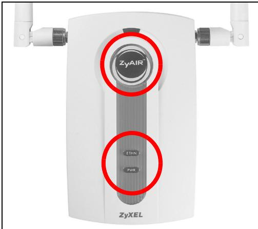
При включении питания загораются индикаторы **PWR** и **ZyAIR**. Индикатор **ETHN** включается при правильном подключении порта **ETHERNET**.
