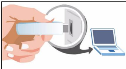
**Note:** Nunca doble, tuerza o fuerce el AG-225H v2 dentro del puerto. Si no hay espacio suficiente para insertar el AG-225H v2, utilice el cable USB incluido.
