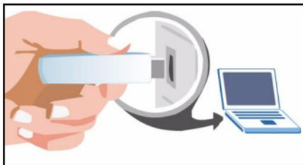
**註：** 將 AG-225H v2 插入連接埠時絕對不可彎曲、扭轉或硬塞。如果沒有多餘的空間可連接 AG-225H v2，請使用內附的 USB 連接線。
