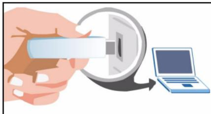
**Note:** Non curvare, torcere o forzare l'AG-225H v2 nella porta. Se non c'è spazio sufficiente per collegare l'AG-225H v2, utilizzare il cavo USB fornito a corredo.
