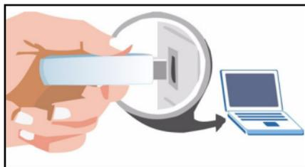
**Note:** Stecken Sie den AG-225H v2 ohne starken Druck und ohne Drehen in den Anschluss. Wenn nicht genügend Platz für den AG-225H v2 vorhanden ist, können Sie auch das mitgelieferte USB-Kabel verwenden.
